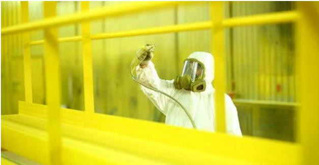
In der werkseigenen Lackiererei erfolgt die Farbgebung in Standard-RAL-Farben umweltschonend mittels Airless-Farbspritzverfahren mit einer Schichtdicke von mindestens 60µ.
